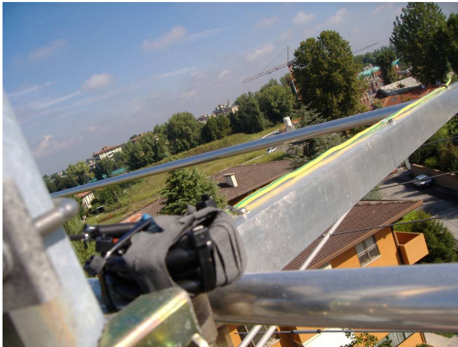
FIG. 9 : altra vista del condensatore e linea adattatore fissata al BOOM con tre viti e cavallotti
